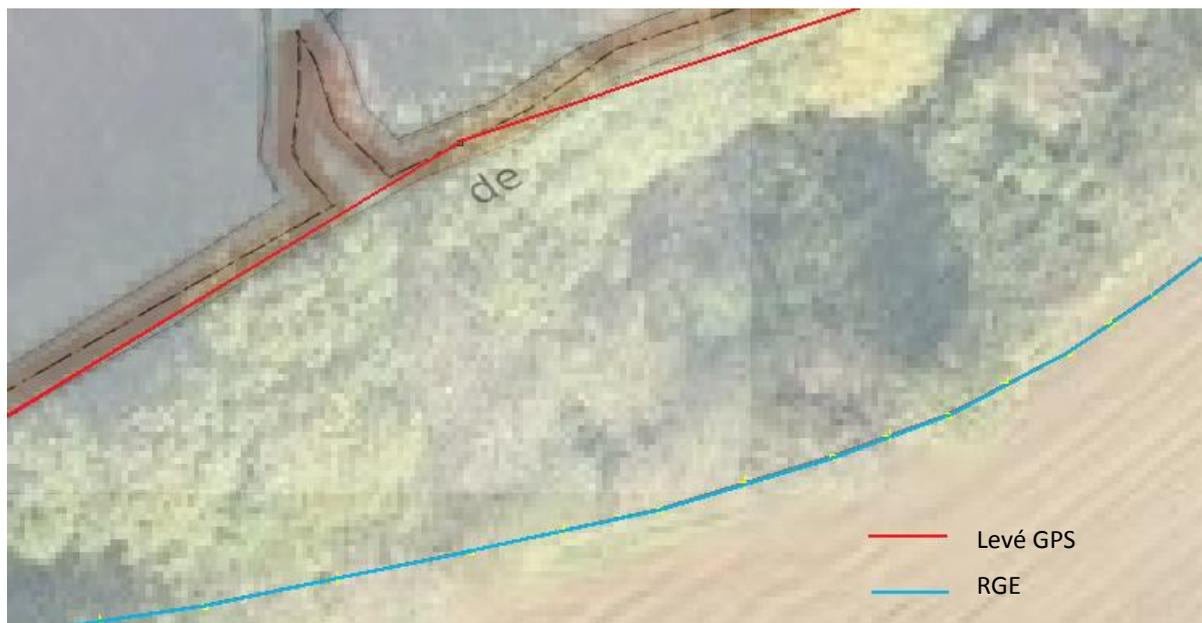
Figure 53 : Le cadastre est conforme au levé GPS tandis que le chemin tracé dans le RGE est faux. Trace GPS simplifiée
